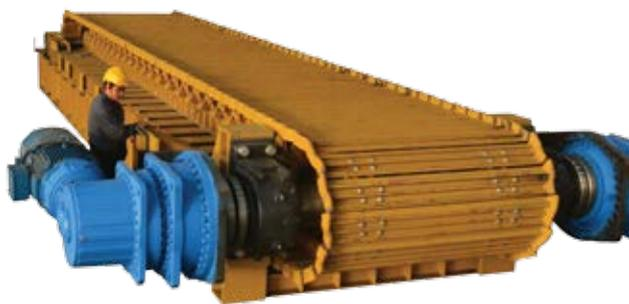
Les pièces soudées robustes du cadre munies de barres anticollision empêchent la déviation. Les rouleaux de type train de roulement lubrifiés et les rouleaux de renvoi permettent une durée de vie prolongée.
