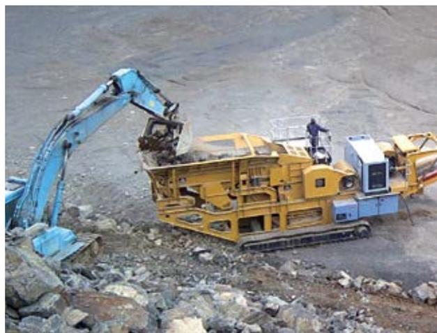
Concasseur à mâchoires, série CT, utilisé en installation portable.
