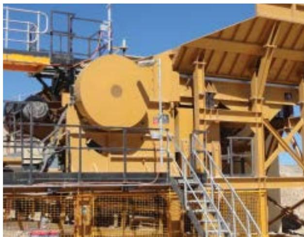
Concasseur à mâchoires, série CT, utilisé dans une installation modulaire.
